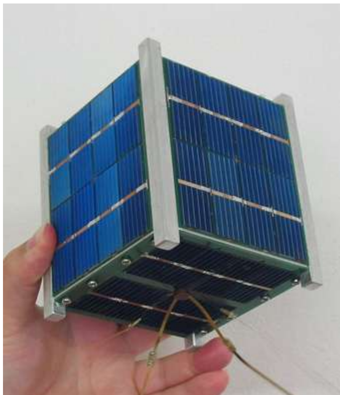
Figura 1 – Exemplo de um CubeSat 1U (10x10x10 cm)
